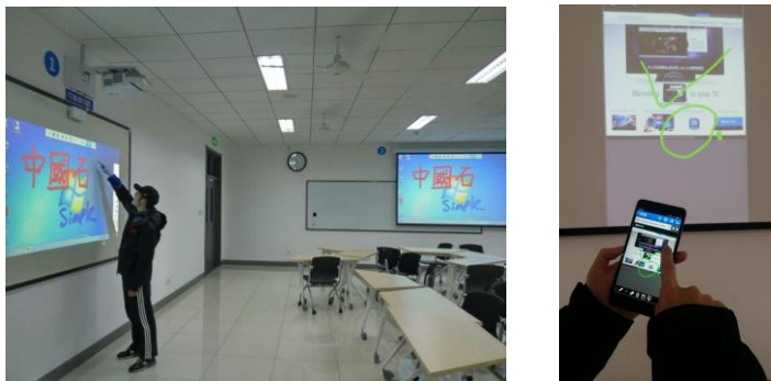
图4触控互动投影以及远程协作系统
